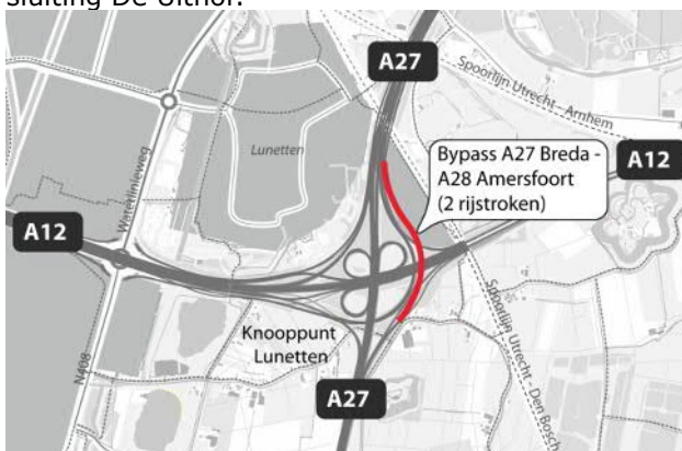
Figuur 3.5: Bypass Knooppunt Lunetten
