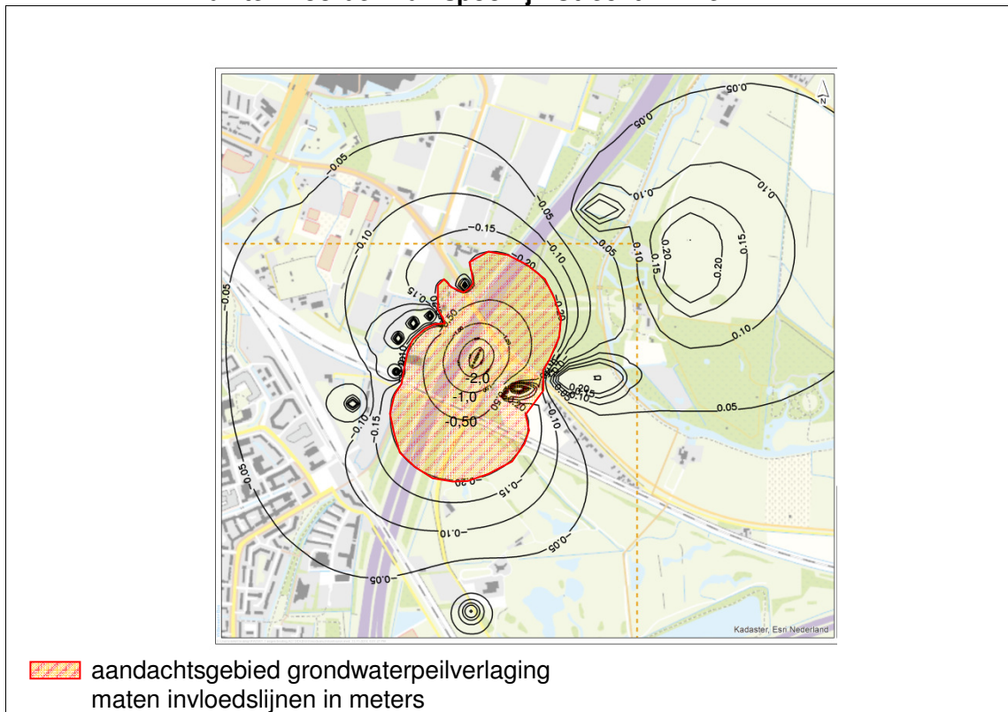
Afbeelding 2.6. Invloedslijnen tijdelijke en lokale verlaging grondwaterdruk in folie- vak ten noorden van spoorlijn Utrecht-Arnhem
